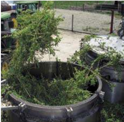
Unmittelbar nach dem Mähen wird die Destillationsanlage befüllt. Dadurch bleiben die wertvollen Öle erhalten.
